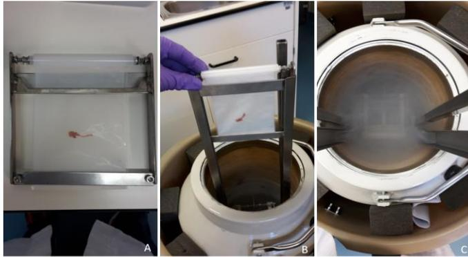
Abb. 1: Handhabung Einfrierautomat. **A)** Eingespanntes Präparat, **B)** Einfrierautomat kurz vor dem Auslösen des Plattenmechanismus, **C)** Präparat in PTFE-Tüte zwischen den tiefkalten Platten im Einfrierautomat
